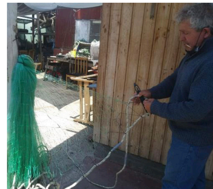
Imagen 1: Encabalgador realizando el proceso de armado de red de enmalle, San Antonio
