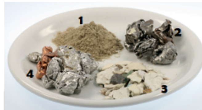
Figura 5. Fracciones de refrigerador obtenidas luego del proceso de separación mecánico. Fuente: Andritz MeWa
