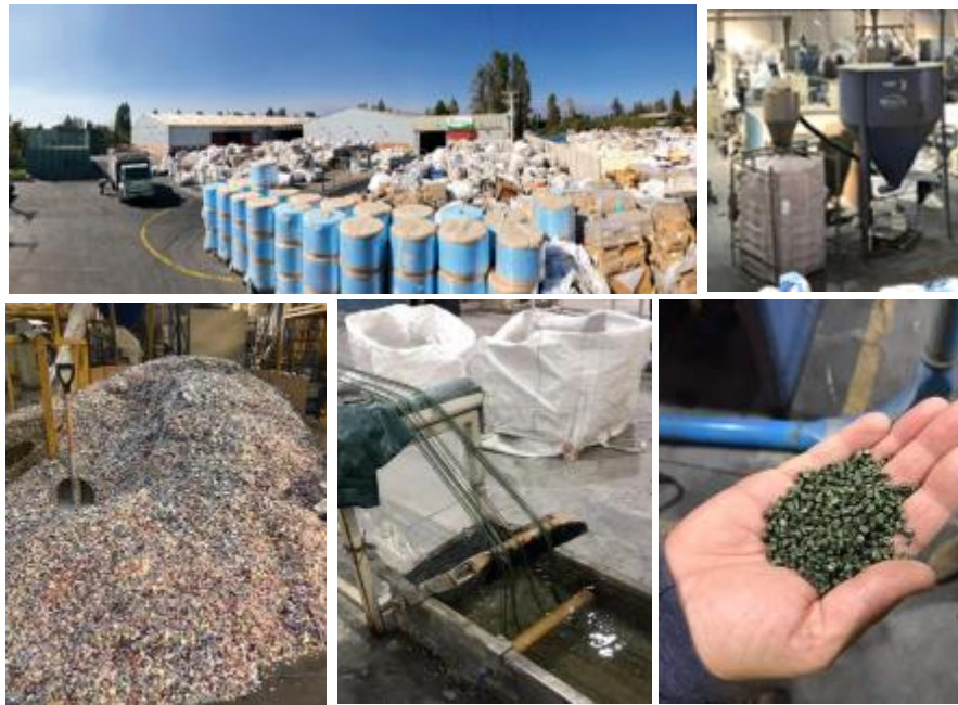
Figura 21. Fotografías material de entrada, molienda, extrusión y pellets producidos de PP
