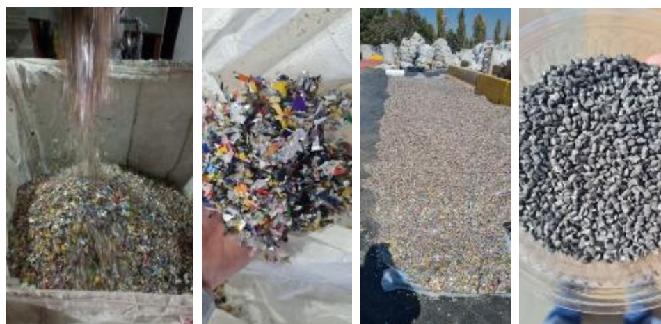
Figura 15. Fotografías procesos de triturado, lavado, secado y producción de pellets de PP.
