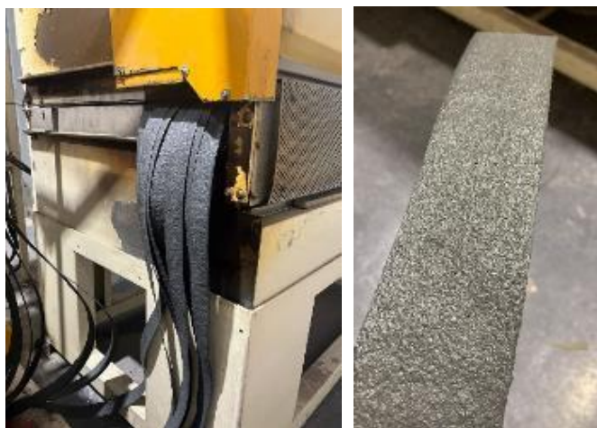
Figura 16. Fotografías de zunchos de PP producidos por Garibaldi con pellet reciclado
